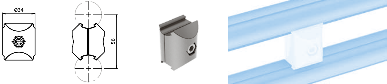
Set Parallelverbinder D28 Set Parallel Connector D28
